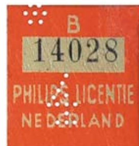
Licentieplaatjes op een Aetherkruiser AK401, met het ingeponste cijfer 4 (exclusief de neon-afstemindicator bevat dit toestel 4 lampen).
