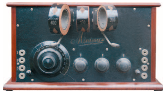
Minimax O.V.3i, 3-lampsontvanger, functioneel gelijk aan de O.V.3, maar met ingebouwde lampen. Van dit model is tot op heden maar 1 exemplaar in verzamelingen/musea getraceerd. Collectie: Radiotron, Hoenderloo; foto: auteur.
