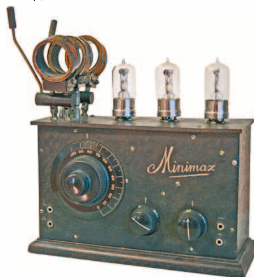
Minimax Populaire, 3-lampsontvanger uit ongeveer 1926. Het afgebeelde toestel is niet met de standaard Philips-lampen uitgerust. Van dit toestel-type zijn 3 exemplaren in verzamelingen/musea aangetroffen. Collectie: Gé Faassen; foto: auteur.
