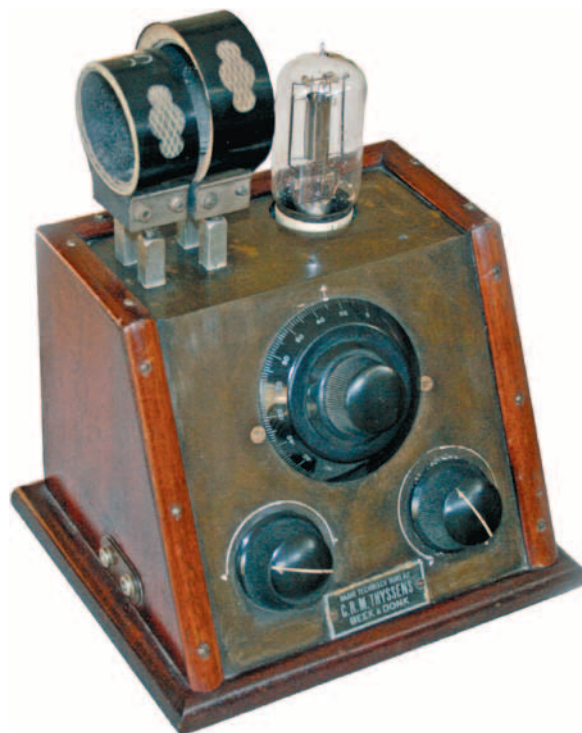
Eenlampsontvanger "Minimum", type O.1, uit 1924, het enige exemplaar dat van dit type bekend is. Let op de karakteristieke halfronde afdeklathjes die de ebonieten panelen opsluiten. Collectie en foto: auteur.
