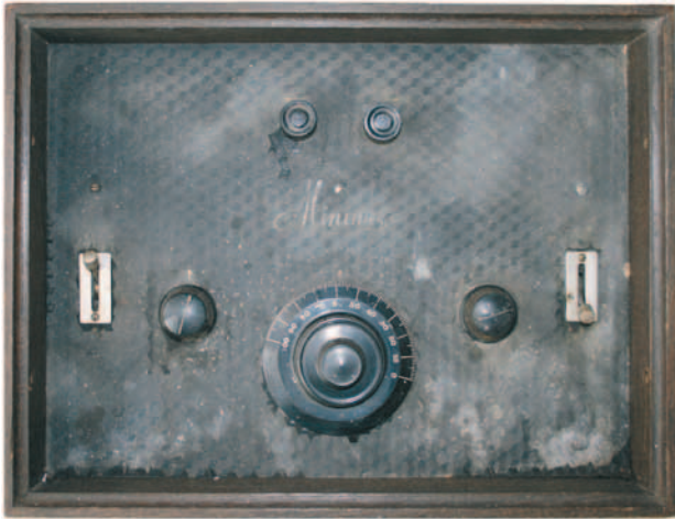
Minimax O.V.B.4 bis, een 4-lampsontvanger die sterk afwijkt van andere modellen. Met dit toestel kan zowel op koptelefoon als op luidspreker geluisterd worden. Het afgebeelde toestel is ondergebracht in een salonmeubel. Collectie: fam. Van Schijndel; foto: auteur.
