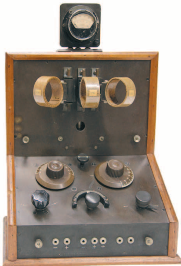
Eenlampsontvanger, afkomstig uit het "Radio Instituut Steehouwer", thans behorend tot de collectie van het "Instituut Beeld en Geluid" in Hilversum. De knop linksonder is niet origineel. Foto: Beeld en Geluid.
