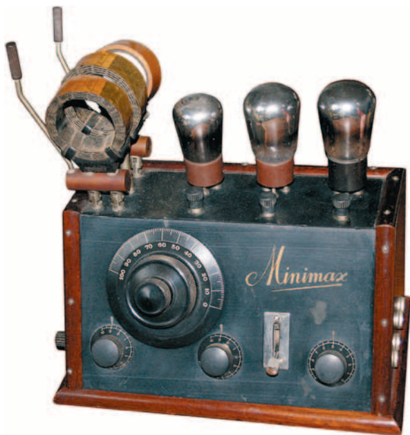
Minimax O.V.3, 3-lampsontvanger uit 1925, mahoniehouten kast, afgewerkt met halfronde afdeklathes, ebonieten panelen. Van dit type zijn de auteur in verzamelingen in totaal 5 exemplaren bekend, enkele reprotoestellen niet meegerekend. Collectie: fam. Van der Aa; foto: auteur.
