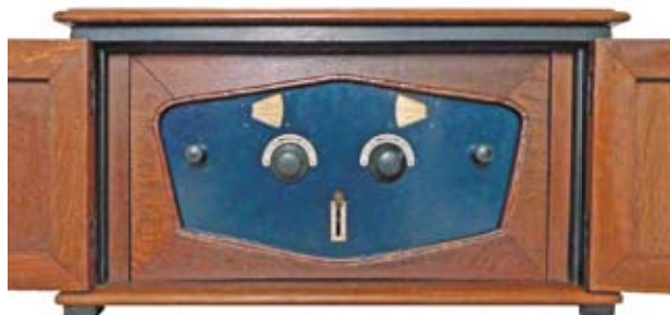
Het eerste NSF4 batterijtoestel uit 1927. Het hendeltje midden onder is voor de omschakeling van het golflengtebereik. (Collectie en foto: John Koster).
