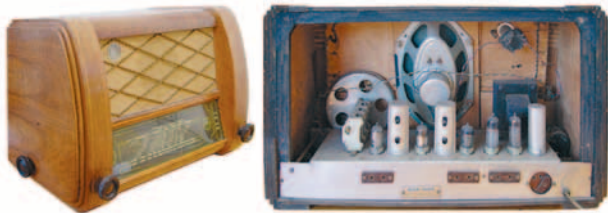
BORAF A501. Wisselstroomtoestel (110, 127, 220 V), met 5 rimlock-lampen en een magisch oog, geschikt voor MG, KG en LG. Het afgebeelde toestel heeft serienummer 942. De luidspreker is mogelijk niet origineel. Foto en collectie: Huub Bergman.
