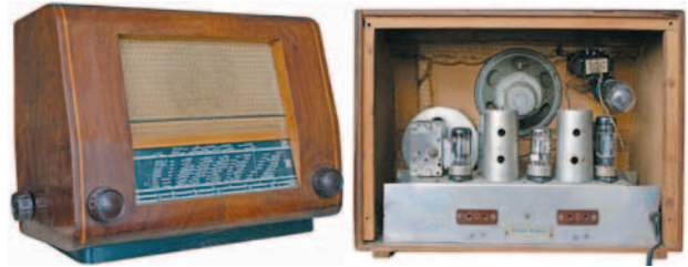
BORAF-wisselstroomtoestel van een onbekend type, voor de ontvangst van MG, KG en LG, met de lampen ECH21, ECH21, EBL21 en AZ1. Het serienummer van het afgebeelde toestel is 566. De kast is fraai afgewerkt, met links en rechts één bieze. Het chassis is evenwel slordig gevormd. Aan de linkerkant op de afstemschaal staat verticaal de merknaam BORAF (op de foto net niet te zien). Foto en collectie: Henk Oudenampsen.
