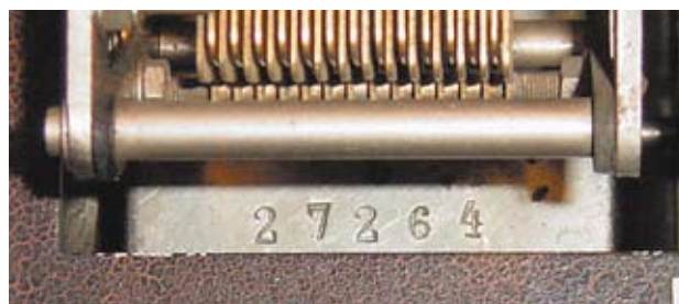
Serienummers op het chassis zijn tot nummer 11.000 ingeslagen in een tussenschot, vanaf 15.000 in een plaatje bij een van de afstemcondensatoren.
