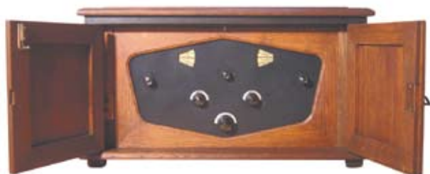
Batterijtoestel uit 1929 (B29) met knopje op het front voor het in- en uitschakelen van de binnenverlichting. (Collectie en foto: Eduard Pavlik, Slowakije).
