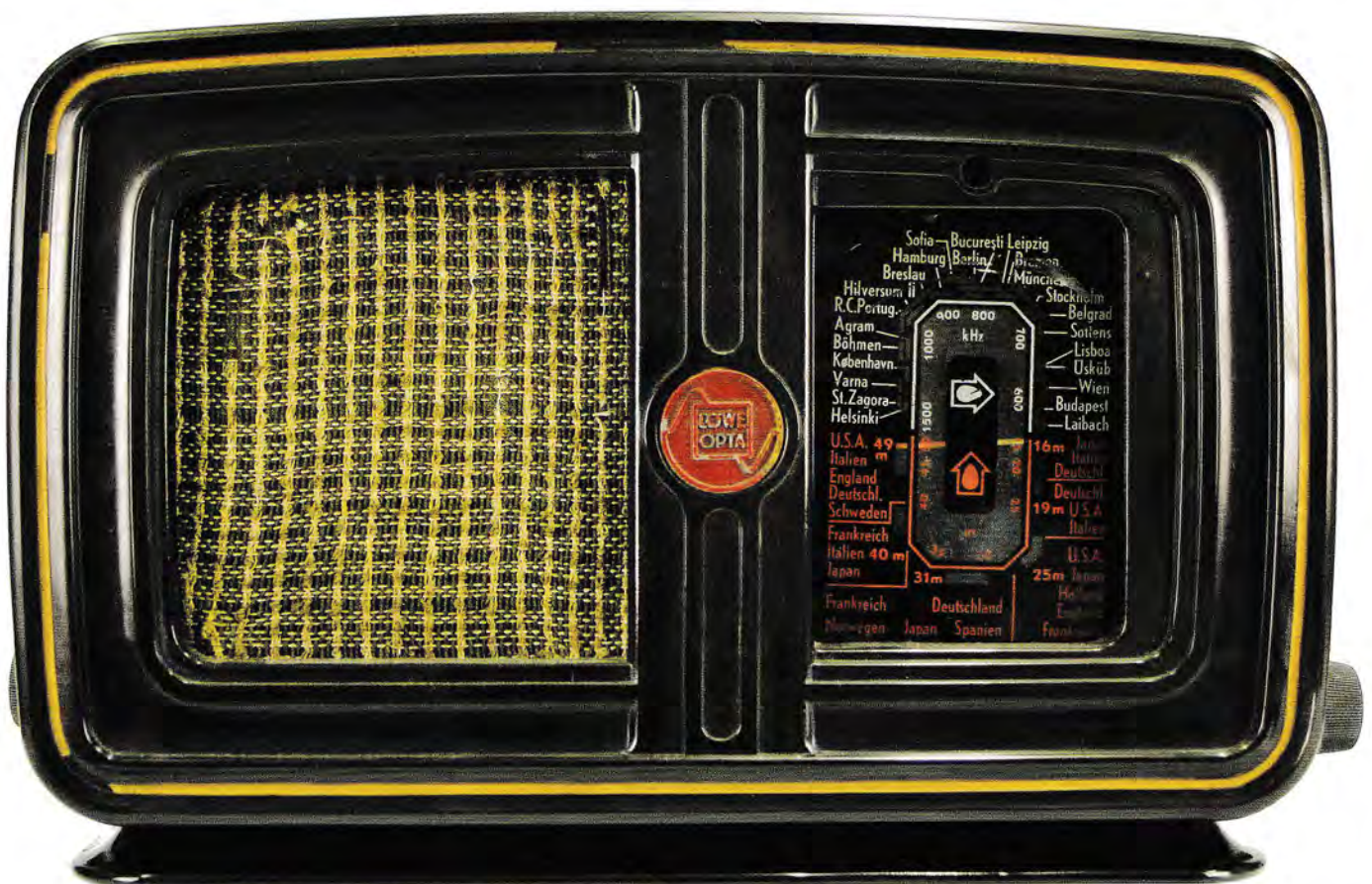
Bild 8. Loewe-Radio Zwergsuper 612GW, basierend auf dem Philips 204U. Das Gehäuse ist teilweise geändert, hat z.B. einen breiteren Mittelsteg mit dem Loewe-Opta-Emblem, wie im zweiten Teil des Artikels beschrieben und gezeigt wird. (Sammlung: J. Gerbig)
