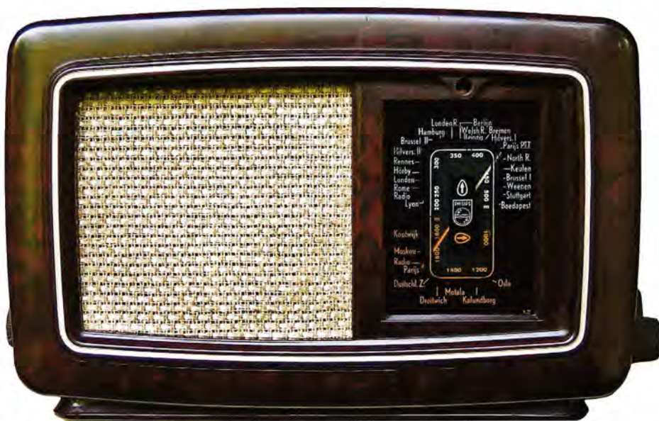
Bild 1. Zwergsuper Philips 203U, auf dem ein Teil der Verlagerungsgeräte basiert. Nur das Gehäuse und die Abstimmkala wurden geändert.
