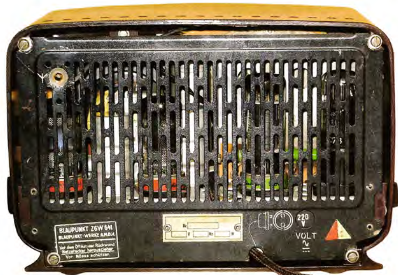
Bild 4. Rückwand des Blaupunkt ZGW641, basierend auf dem Philips 203U. In der Mitte unten das „neutrale“, goldfarbige Philips-Typschild, ganz links der Blaupunkt-ZGW641-Aufkleber und rechts das IGR-Lizenzschild. Am oberen Rand sind die 17 Lüftungslöcher sichtbar.
