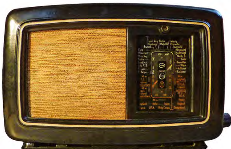
Bild 6. Zwergsuper Philips 204U, äußerlich gleich mit dem 203U, nur die Skala ist anders. Bild: John Koster (NL)
