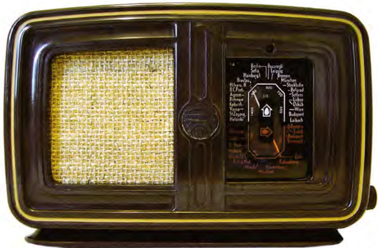
Bild 2. Hornyphon 637L, basierend auf dem Philips 203U. In der Mitte des Mittelstegs ist das Hornyphon-Emblem montiert. Bild: Timo Rantasaari (Finnland)
