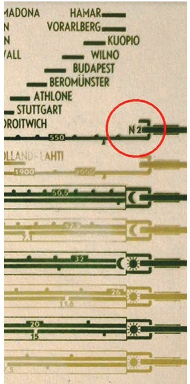
Rechter deel van de schaal van een Philips BX680A (1948), met rood omcirkeld de geografische aanduiding N2. Op de foto is het codenummer van de schaal (A3 219 21.2) niet zichtbaar.
