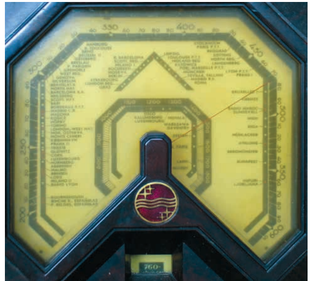
Afstemschaal van een Philips 638A (1934). Op het transparante (celluloid) venster vóór de afstemschaal staan de golflengtes, op de schaal daarachter de zendernamen. De schaal met zendernamen kan men eenvoudig aan de bovenkant uit de omlijsting schuiven en vervangen door een schaal met andere zendernamen (voor een ander geografisch gebied). De omlijsting van de afstemschaal verbergt het codenummer van die afstemschaal (links onder, hier 28 695 443). Foto en collectie: Hans op den Camp.
