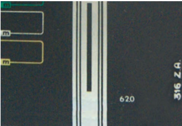
Nog een voorbeeld van een schaalnummer. Hoek rechtsonder van de uitgekaste afstemschaal van een Philips 316X, met bestemming Zuid-Afrika. Het schaalnummer 62.0 is ook in ingekaste situatie rechtsonder zichtbaar.
