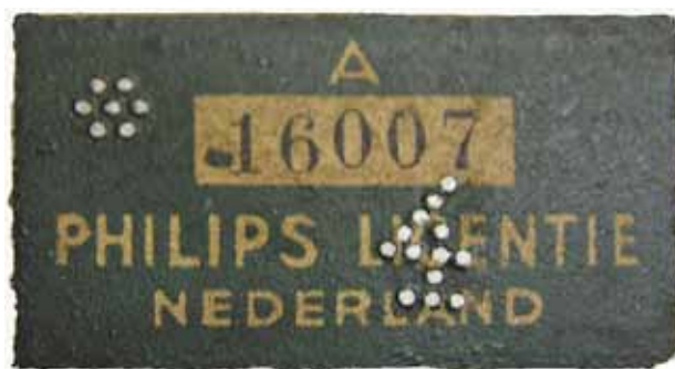
Licentieplaatje op een Erres KY175 uit 1940, met het ingeponste cijfer 4 (er moest in dit geval voor 4 lampen licentievergoeding betaald worden). Bij Erres-toestellen is het A-plaatje aan de achterkant op het chassis en het B-plaatje aan de binnenkant op de kast aangebracht.
